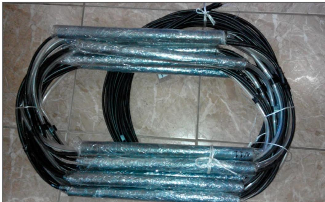
Общий вид анодной сборки 14 шт. анодов (14АЗТ38-500), вместе с газоотводящей полиэтиленовой трубкой 10мм и силовым тросом 2 мм
