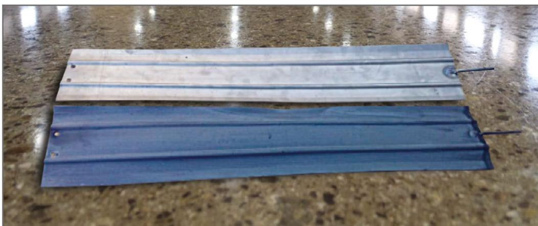
Плоский титановый анодный заземлитель А3100х500, с покрытием из диоксиде марганца (темный) и без покрытия (светлый).
